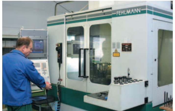
CNC - HSC - Bearbeitungszentrum Fehlmann Picomax 60-M außerdem ein CNC Bearbeitungszentrum DMG 104V linear
