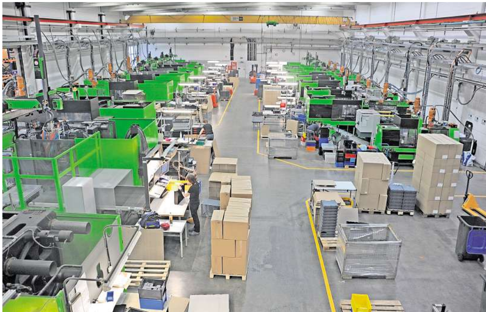
Im Werk I befindet sich die Spritzgussproduktion. An 20 Maschinen werden aus Polypropylen die verschiedensten Koffer gepresst.
